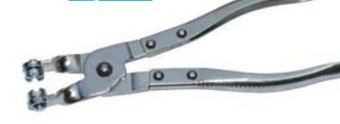
In robusta lamiera d'acciaio. Tipo per anelli a molla con sezione tonda semplice. Ganasce con tasselli girevoli a 360° provviste di incavi per l'introduzione delle estremità degli anelli anche in posizioni di difficile accesso.
